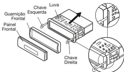
6. Montar a luva introduzindo-a na gaveta, dobrar as abas situadas em torno da luva com uma chave de fenda. Nem todas as abas serão adequadas, verifique aquelas que fazem a melhor fixação. Abra e dobre as abas na gaveta para fixar a luva corretamente.
