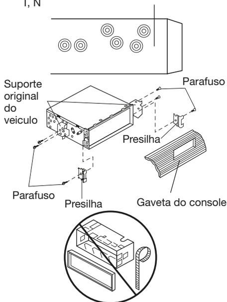
Para fixar o equipamento nos suportes do radio original de seu carro, alinhe as roscas de parafuso do TRC-1300U com as roscas de parafuso dos suportes de seu veículo, aperte os parafusos (5x5 mm) em cada lado.
