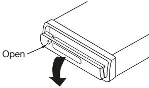
2. Para remover o painel frontal pressione-o em direção à esquerda em um pequeno ângulo na posição horizontal, primeiro retire o lado direito e depois o lado esquerdo.
