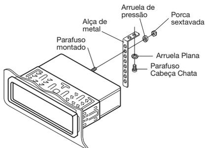
Nota: Instalar o terminal de rosca curta no parafuso montado na parte de traz do equipamento e o terminal de rosca longa na gaveta de instalação do veículo.
